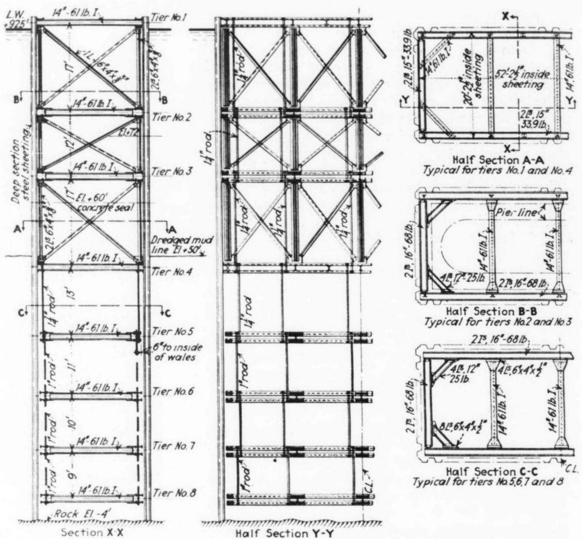
FIG. 5—DETAILS OF STEEL COFFERDAM BRACING
