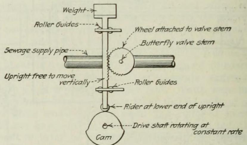
FIG. 1—METHOD OF CONTROLLING BUTTERFLY VALVE TO GIVE VARIABLE SPRINKLER-NOZZLE PRESSURE
