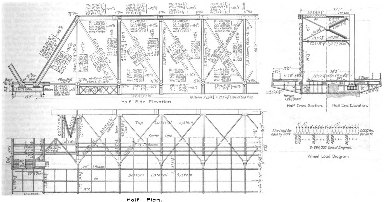
FIG. 3.—DETAILS OF NEW TRUSS SPANS FOR THE VICTORIA JUBILEE BRIDGE.
